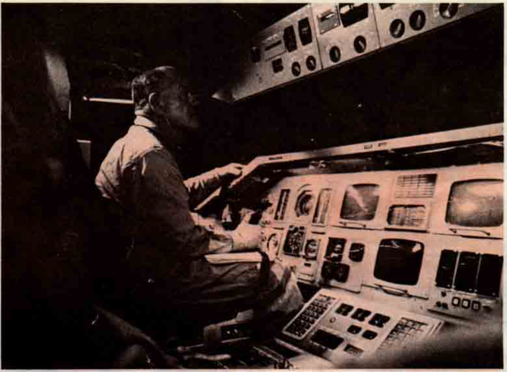
Uzay taksisinin (Mekikinin) Kaptan pilot kabinesi (Cockpit). İstikamet Kumandası (steering) normal bir yolcu uçağınkine benzemektedir. Sağda on iki televizyon ekrandan üçü görünmektedir. Foto: NASA.
